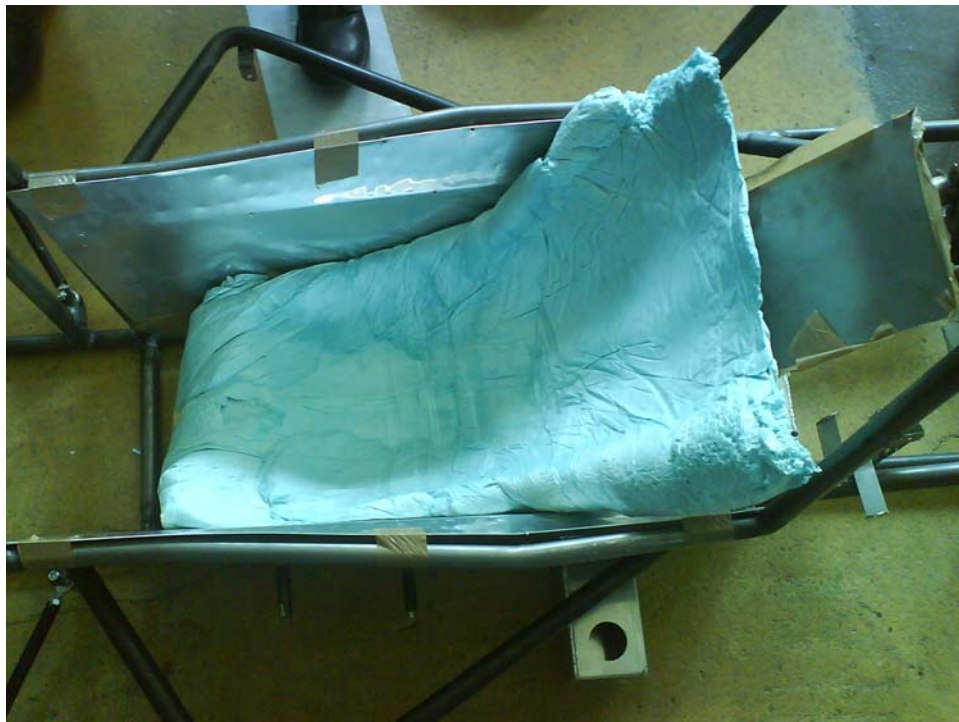
Abb.: Sitzschale nach drittem Schaumvorgang
